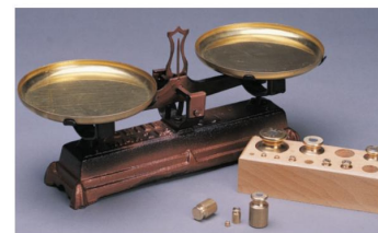
Balance Roberval et boîte de masses marquées
